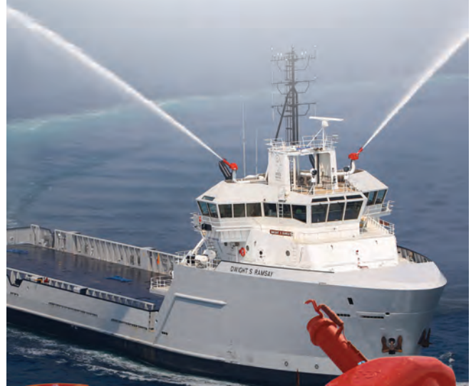
Fire monitors 300 cu m/hr - 3600 cu m/hr
