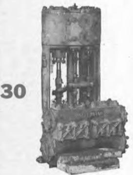
**T-2 TANKER BILGE, BALLAST AND FIRE PUMP**
