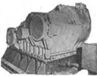
**DOUBLE INPUT—SINGLE OUTPUT DIESEL REDUCTION GEARS**
