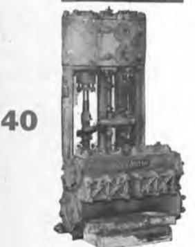
**40** **T-2 TANKER BILGE, BALLAST AND FIRE PUMP**
